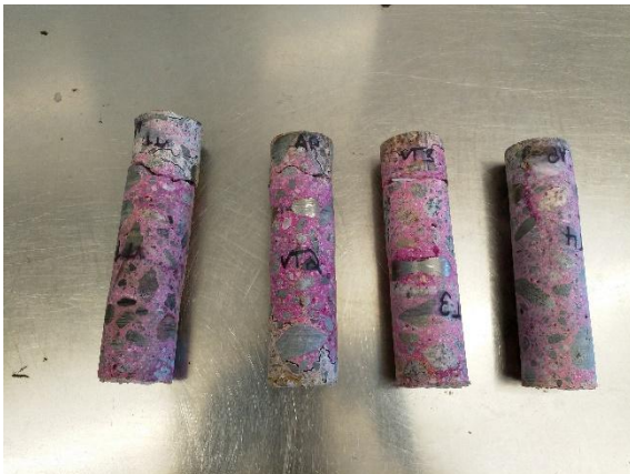
Kuva 4 Kantavan laatan näytteet fenoliiftaleiinikäsittelyn jälkeä.
